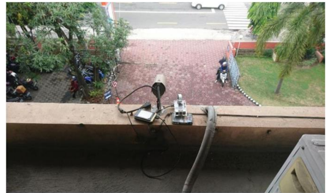
Gambar 8. Instalasi perangkat Raspberry Pi dan kamera
