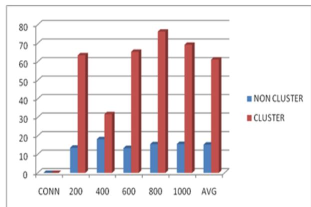
Gambar 13. Grafik Perbandingan Throughput Single Server dan Load balance
