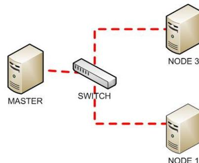
Gambar 11. Topologi Load balance Dengan 3 Node Cluster
