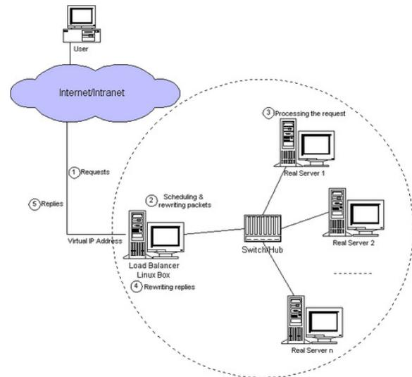
Gambar 6. Topologi Load balance Dengan LVS-NAT
