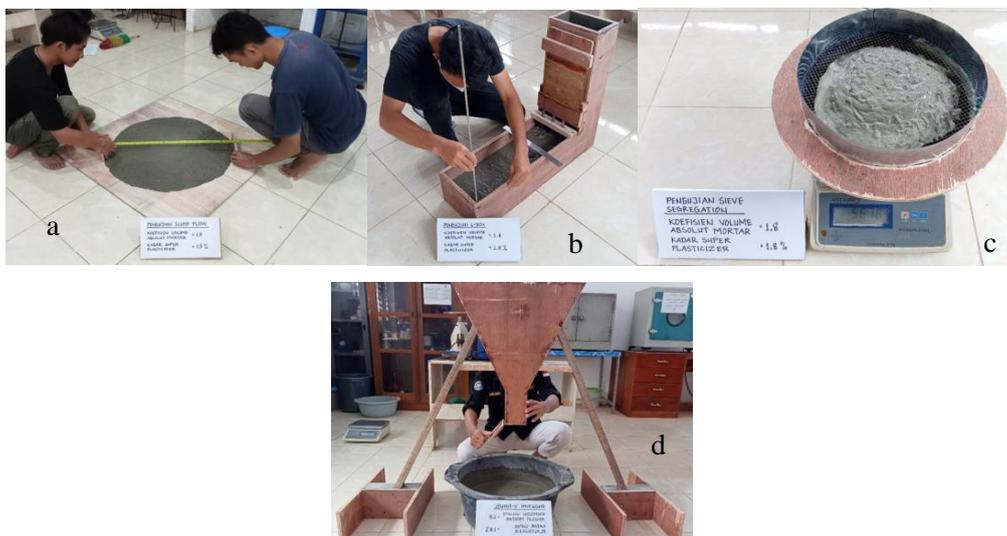
**Gambar 11.** Pengujian Reologi Beton Segar
