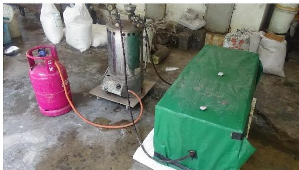
**Gambar 1.** Penguapan Benda Uji
