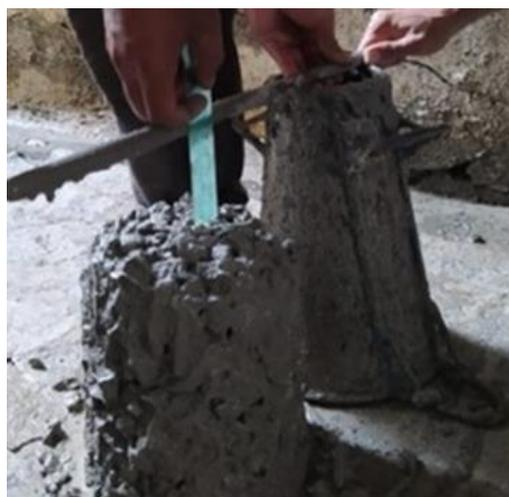
**Gambar 4.** Pengujian *Slump*
