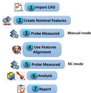
Gambar 2. Basic pengukuran CMM
